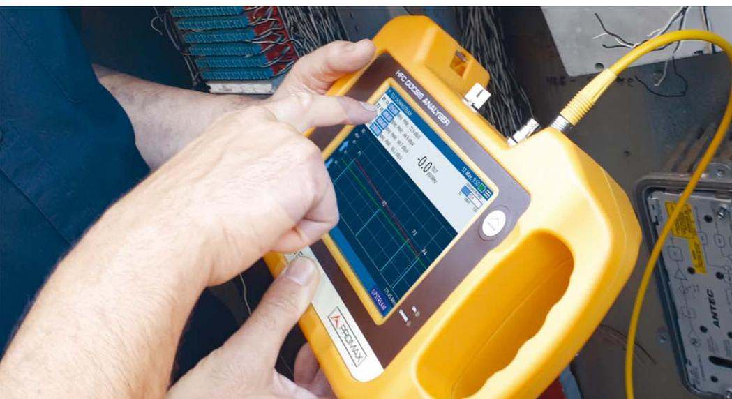
**El CABLE RANGER 3.1** incorpora un cable módem DOCSIS 3.1 y un margen de frecuencias RF desde 5 hasta 1800 MHz
